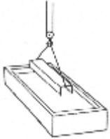
Residui di grassi e oli vengono invece puliti con un bagno di sgrassaggio , per il quale sono impiegate soluzioni alcaline o acide diluite in acqua. Ad esso segue una breve immersione dei pezzi in acqua per sciacquare le superfici dalle soluzioni di sgrassaggio .
