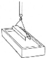
Il manufatto è successivamente sottoposto a decappaggio , normalmente eseguito a temperatura ambiente, per eliminare gli strati contaminanti propri dell'acciaio. Generalmente, a tale scopo viene utilizzata una soluzione di acido cloridrico diluito: la durata del decappaggio dipende dalla concentrazione del bagno e dal grado di ossidazione del pezzo da zincare.
